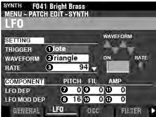
Auf dieser Seite können Sie den LFO (Low Frequency Oscillator) einstellen, der Vibrato- oder Tremolo-Effekte erzeugt.
