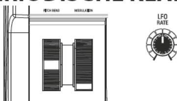
Verwenden Sie den LFO (Low Frequency Oscillator), um periodische Klangmodulationen wie Vibrato oder Tremolo hinzuzufügen.
