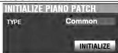
Wählen Sie mit dem [VALUE] Regler die zu initialisierenden Parameter aus. Setzen Sie dann den Cursor mit dem [DIRECTION] [▼] Taster auf das [INITIALIZE] Symbol und drücken Sie [ENTER].
